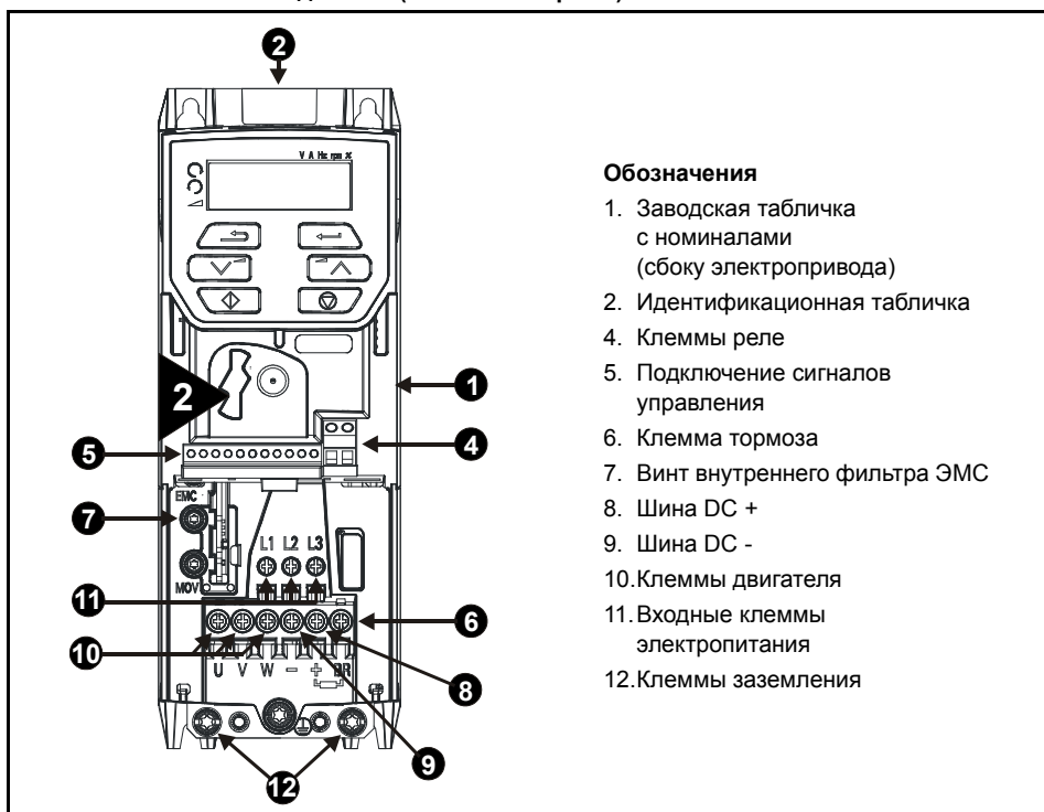
Рис. 3-1 Расположение деталей (показан габарит 2)
